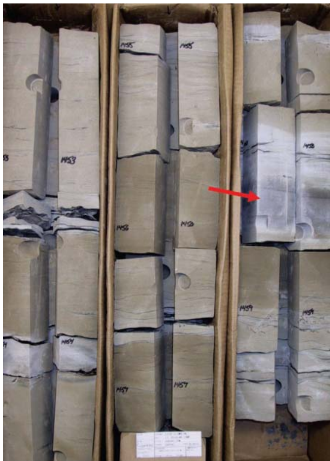
Рис. 3. Фотография кернов, показывающая неоднородность пород месторождения Лоуренс. Цементированный кальцитом интервал (показан стрелкой) имеет очень небольшую пористость и проницаемость и создает барьер для течения флюидов
