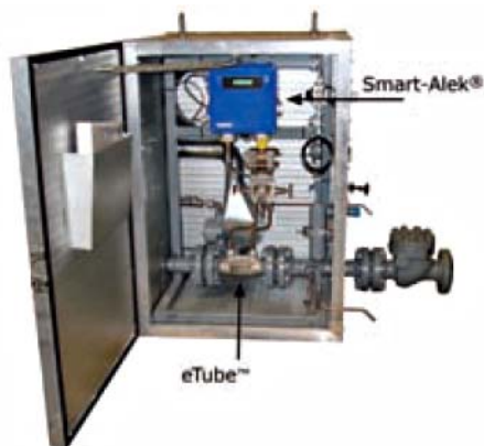
Рис. 2. Смонтированные на салазках портативные системы измерения расхода компании Zedi, которые были использованы для сбора подробной информации о добыче из 2500 неглубоких газовых скважин
